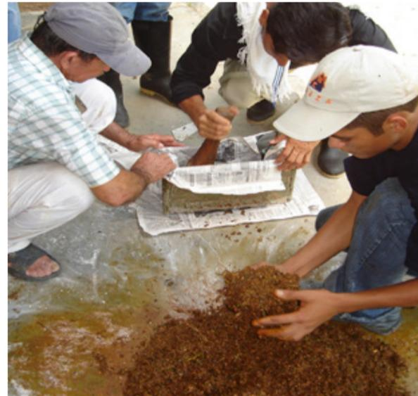
Figura 46. Moldeamiento y prensado
