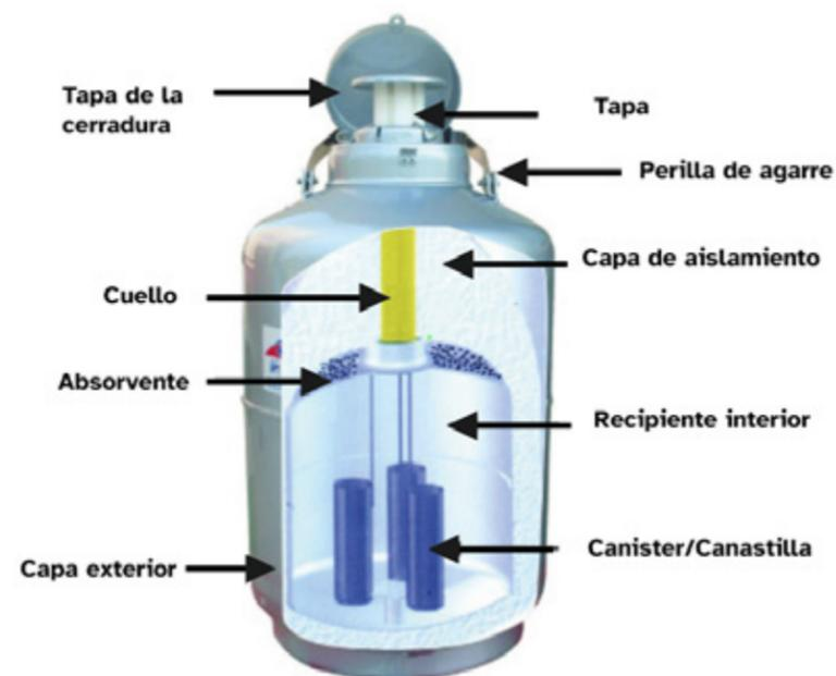
**Imagen 7.** Estructura y componentes del termo de nitrógeno líquido. Fuente: <https://cutt.ly/Ew7wUj>
