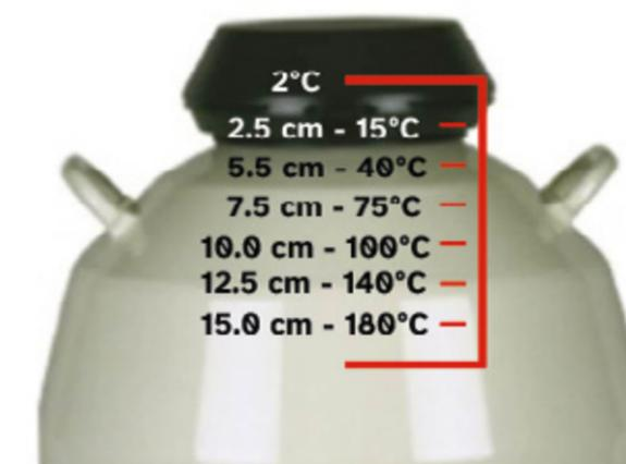
**Imagen 8.** Variaciones de temperatura en el cuello del termo de nitrógeno. Fuente: <https://cutt.ly/Iv7zck>
