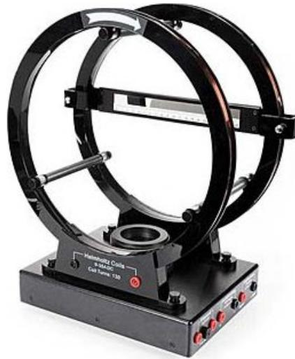
Figura 4.21: Bobinas de Helmholtz
