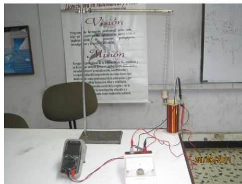
Figura 2. Montaje Construido para el análisis de la Inducción Electromagnética
