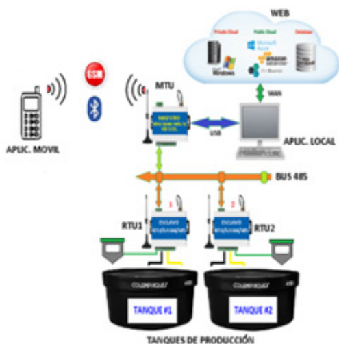
Figura 2. Arquitectura Tecnológica S.A.R.A. V 1.0 Fuente: Autores
