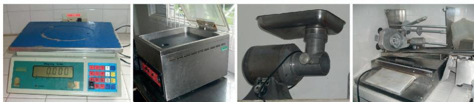
l. Balanza electrónica      m. Empacadora al vacío      n. Molino      o. Amarradora
